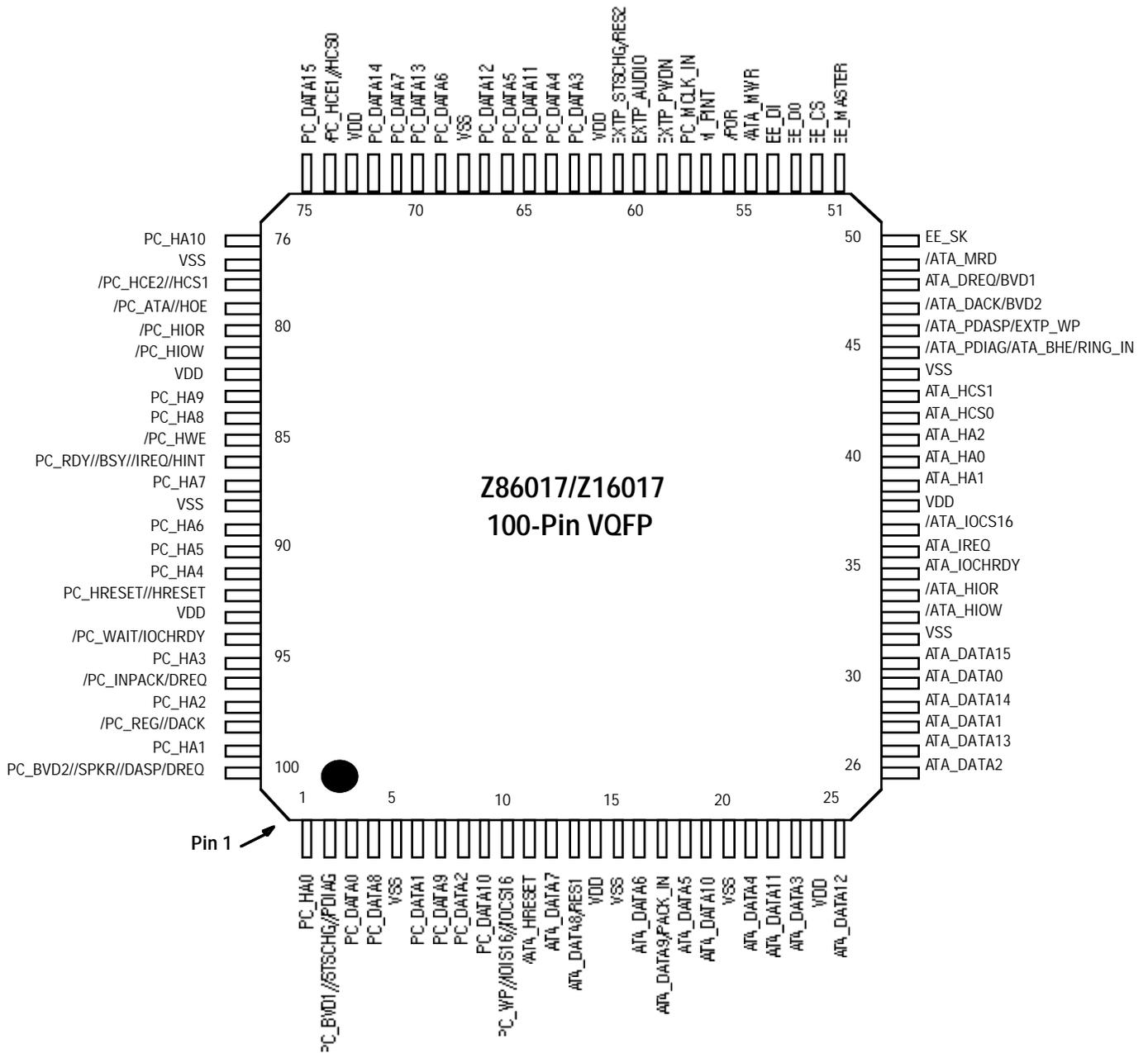
Figure 1-8. 017 100-Pin VQFP Pin Configuration
